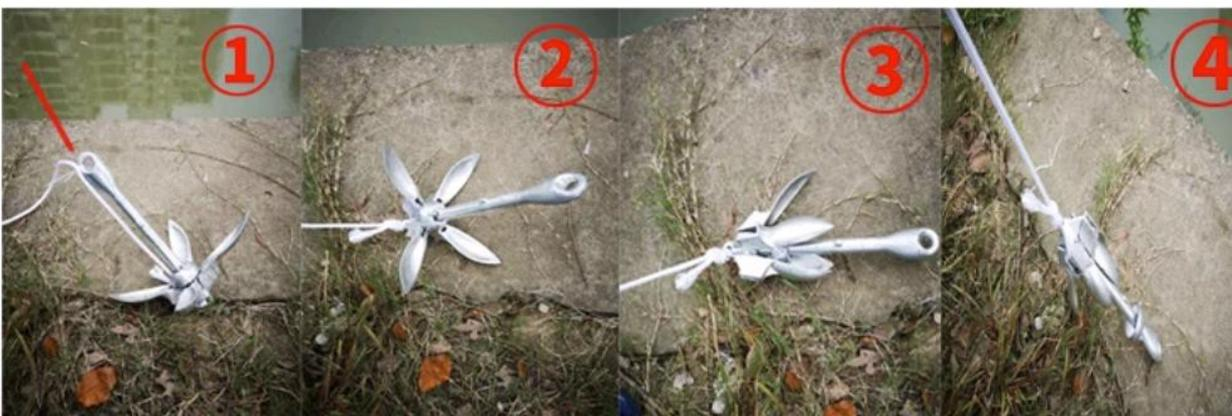
**建议：**将锚绳按照如图1捆绑，若船锚放入水中勾住异物，可用力拉扯锚绳，使白色捆扎绳（图1）处断裂，使锚爪朝下，船锚顺利收起。
